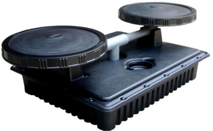
El difusor de burbujas gruesas proporciona mezcla y aireación al mismo tiempo. Los orificios están en la base y cubiertos por la membrana sin agujero como una válvula de retención. Cuando el aire es cesado, el agua no retrocederá en el tubo de aire.
